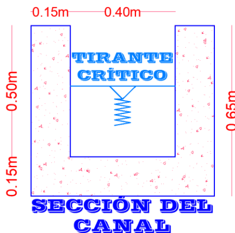
Sección típica del tramo 6
