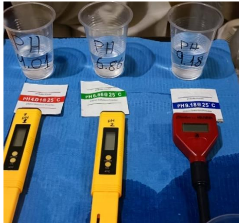
Figura 13: Calibración de pH metro digital con soluciones calibradoras.
