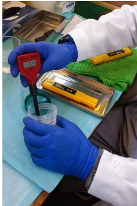
Figura 8: Medición del pH salival con el pH metro digital.
