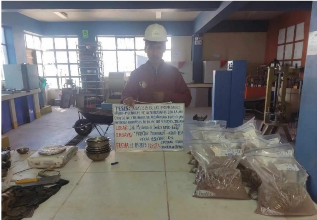
Fotografía N°11. Preparación de muestras para ensayo de Proctor modificado
