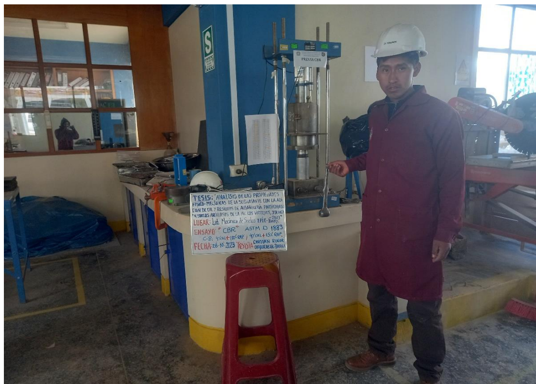
Fotografía N°18. Penetración a los especímenes en la prensa CBR.
