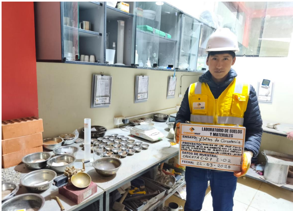
Fotografía N°26. Ensayo de límites de consistencia.
