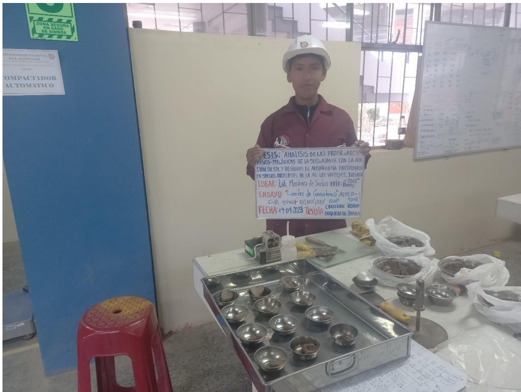
Fotografía N°09. Peso seco de muestras representativas para cálculo de límites de consistencia.
