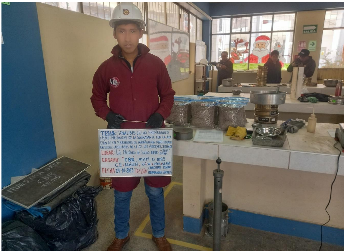
Fotografía N°13. Preparación y humedecimiento de muestras para ensayo de CBR
