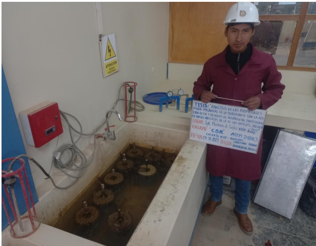
Fotografía N°17. Inmersión de especímenes CBR en el baño de agua.
