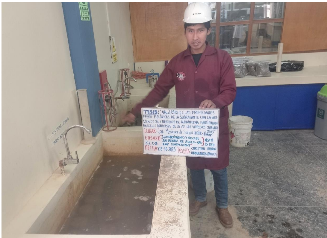
Fotografía N°22. Inmersión de testigos de control en el baño de agua, para ciclos de humedecimiento y secado de mezclas de suelo – cal – RAP
