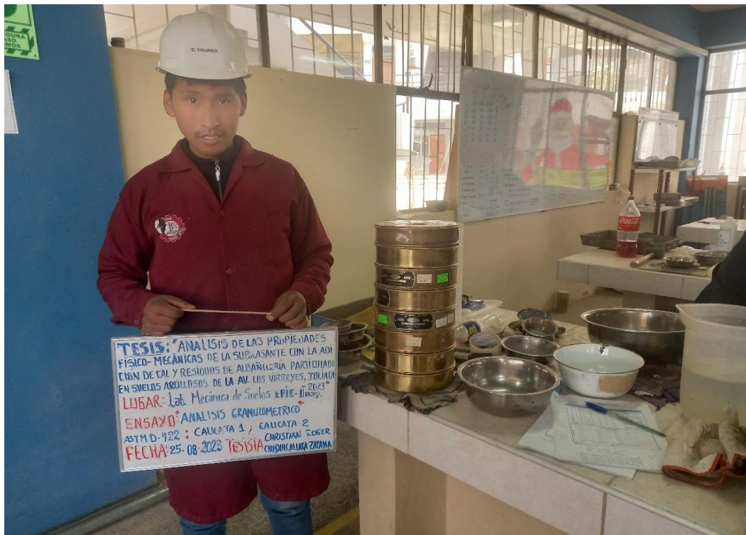
Fotografía N°07. Ensayo de análisis granulométrico por tamizado.
