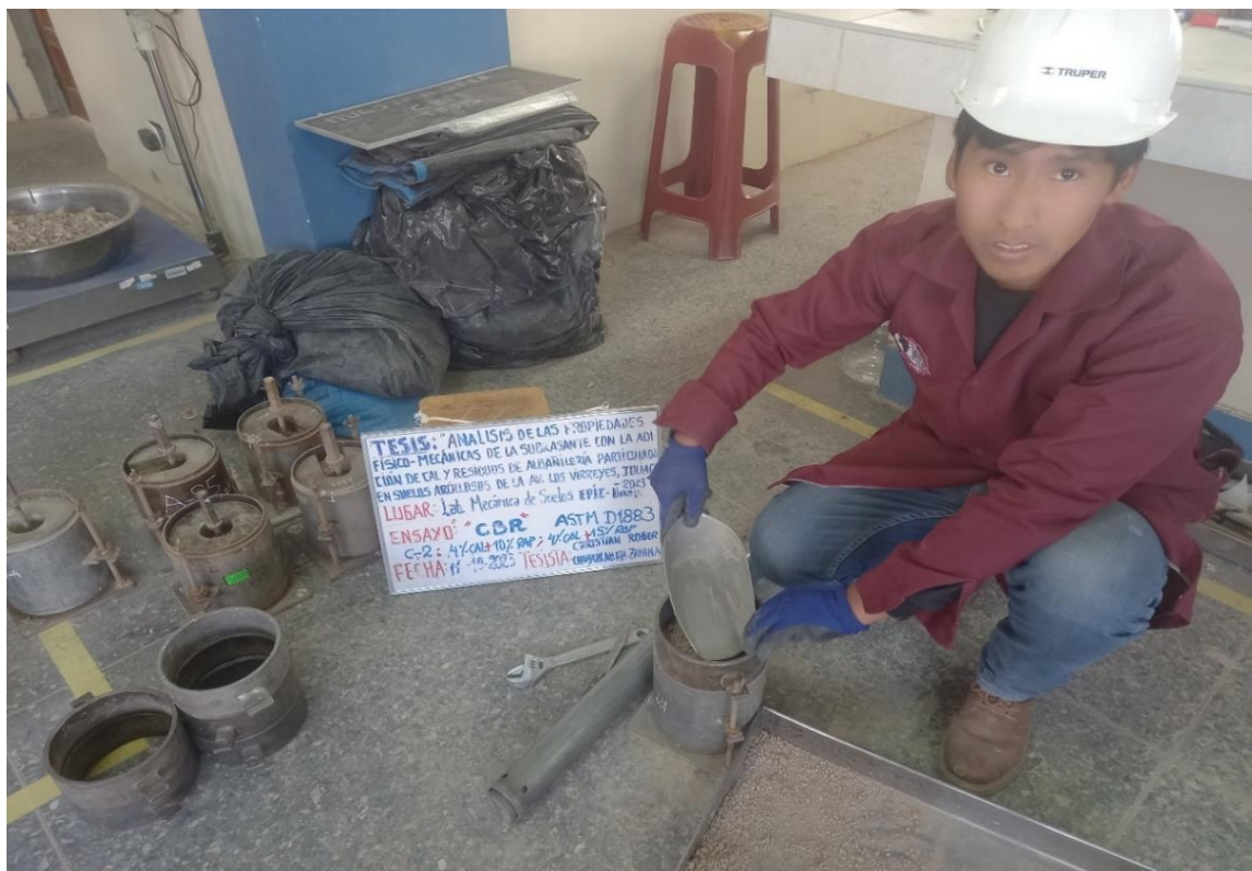
Fotografía N°14. Colocado de una fracción de muestra en el molde CBR 4”.
