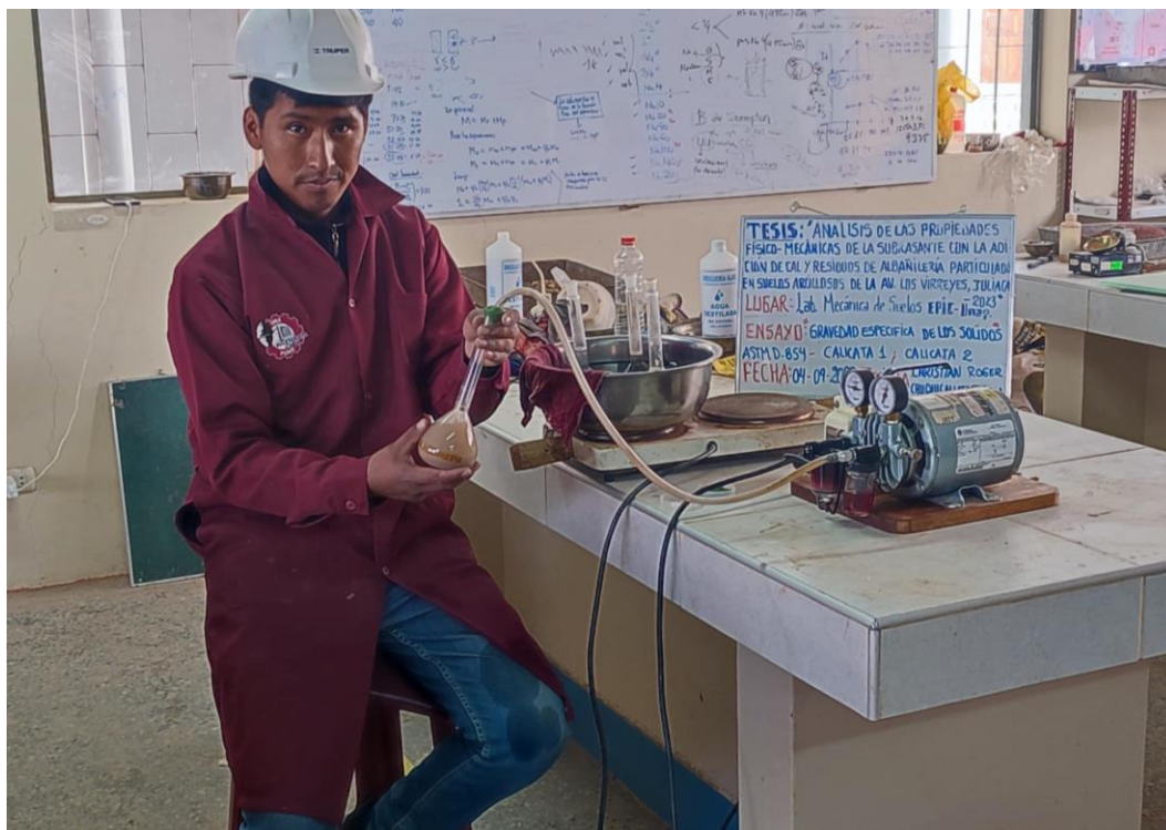
Fotografía N°10. Ensayo de gravedad específica de los sólidos.
