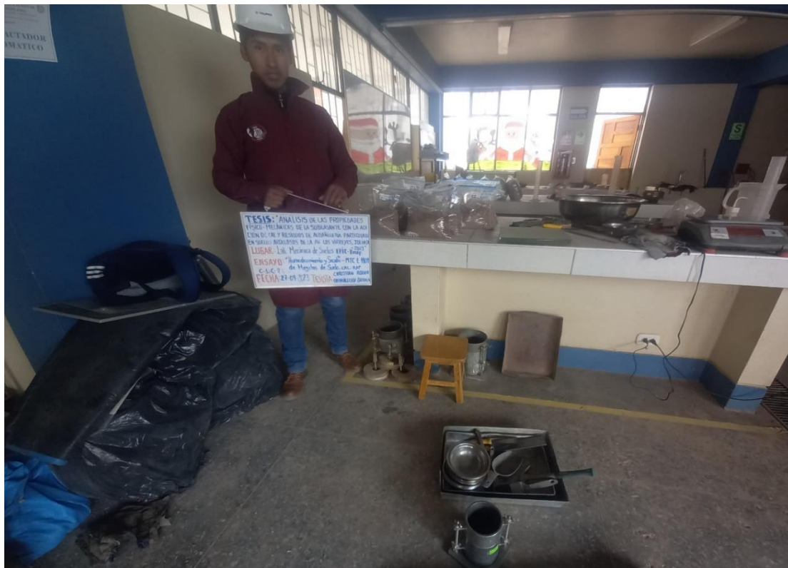
Fotografía N°19. Preparación de muestras para ensayo de humedecimiento y secado de mezclas compactadas de suelo – cal - RAP.
