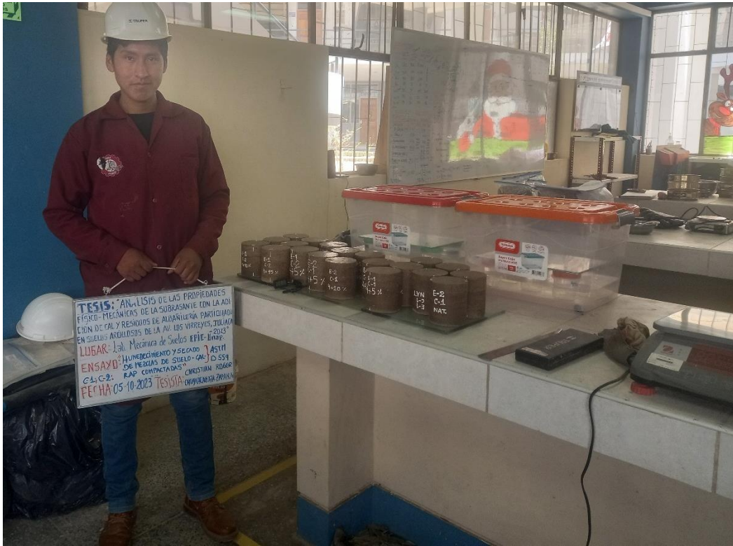
Fotografía N°21. Testigos de control para ensayo de durabilidad.
