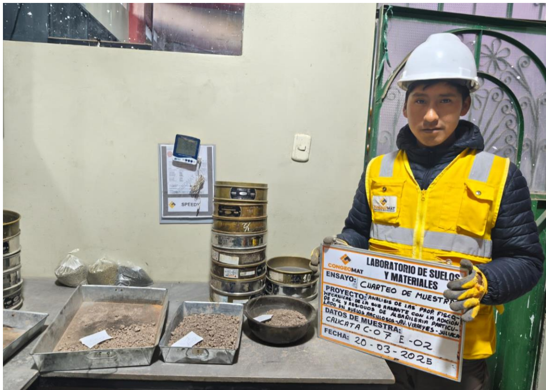
Fotografía N°25. Cuarteo de muestra para análisis la clasificación de suelos.
