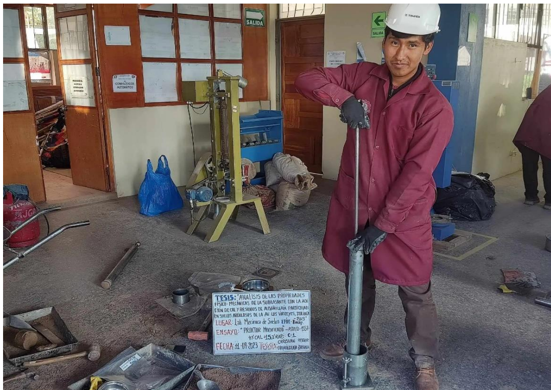
Fotografía N°12. Compactación de muestras en el molde Proctor 4''.
