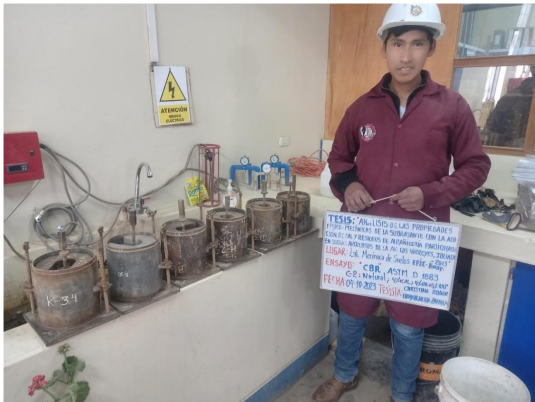
Fotografía N°16. Instalación de placa y pesas para control de expansión.
