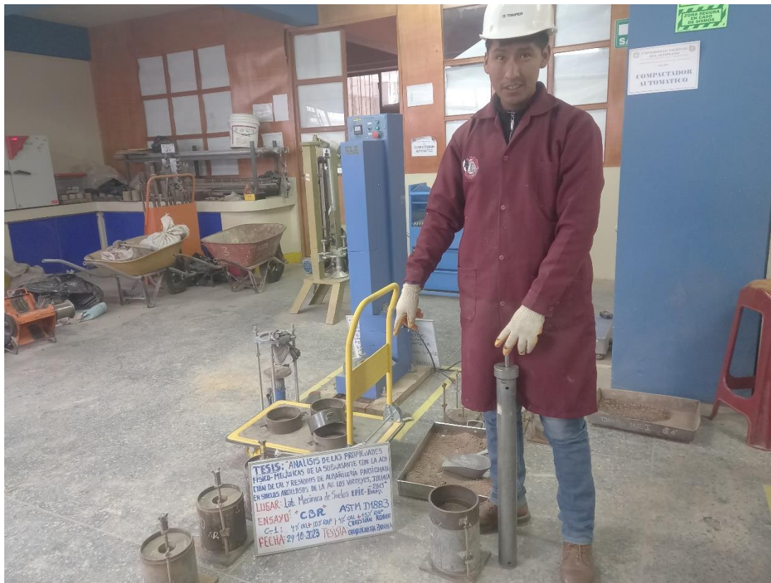
Fotografía N°15. Compactación de muestras suelta en el molde CBR.
