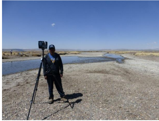
Figura N° 29: Tomada de datos con escáner Faro
