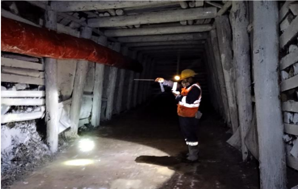
Nota. Monitoreo de velocidad de aire en cámara 130
