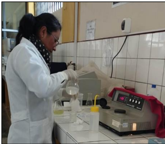
13.9: Lectura de transmitancia de sulfatos en el espectrofotómetro
